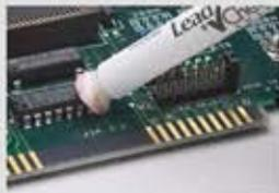
Kit de test Lead Check pour contrôler facilement et rapidement la présence ou l'absence de plomb sur les surfaces de composants, et les surfaces brasées en général.
